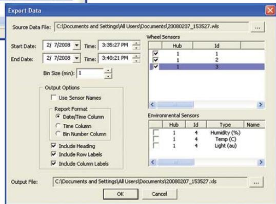
専用のソフトウェアにより、運動量(回転数)データを収録します。データは専用のファイル形式にてデータベースとして記録されます。またデータ Excel ファイル形式で出力可能で、出力範囲は任意で選択可能です。オプションの温度、相対湿度、光レベルセンサーをホイールデータと関連付けが可能です。
