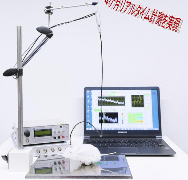
Invilog Research 社は、フィンランド・クオピオ大学薬理・毒性学教室 Prof.Leonid Yavich らによって長年の研究・開発で完成された 最新式 インビボ・ボルタメトリーシステムです。装置導入時には、十分な Web(16hr)トレーニングサービスがなされ、安定した確実な脳内神経物質のリアルタイム・連続観察を実現します。
