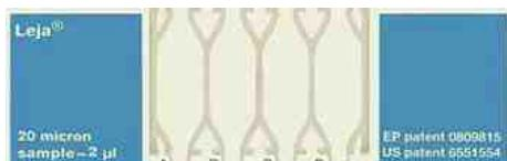
新しいデザインの Leja® 2-チャンバー、Leja® 4-チャンバーのような直線的流入の場合、補正係数が唯一の定数です。これにより、血球計を利用して得た数値と同等の正確な細胞数が測定できます。
