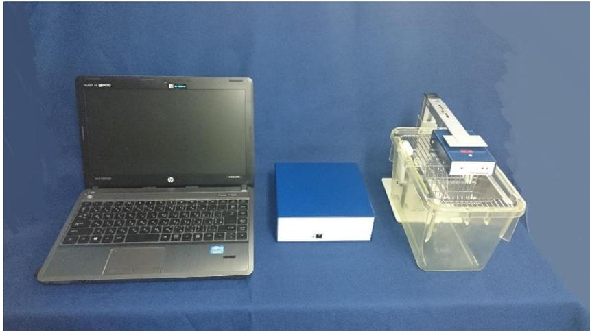
本システムは、弊社製自発運動量センサーや、回転かご、飲水センサー、摂食センサー等と接続し、動物の行動量や、飲水量、摂食量などを単位時間ごとに記録することができます。チャンネルごとに独立スタート、ストップが行えるため、薬物投与等による短期行動量の変化を効率的に測定できます。
